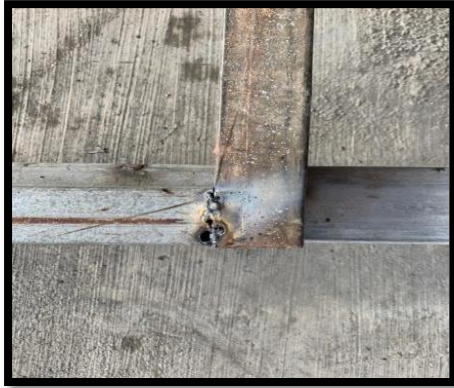
Gambar 3. Contoh Kecacatan Pengelasan
